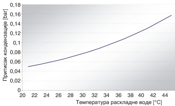
Слика 2. Промена притиска у кондензатору са порастом температуре расхладне воде
