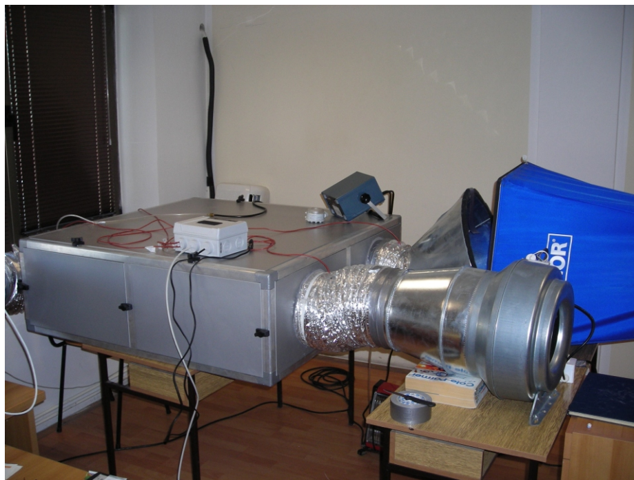
Слика 2. Инсталација за испитивање рекуператора са мерним уређајима
