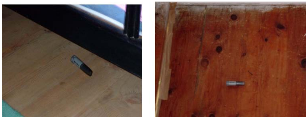
Слика 2. Постављање EL-USB data logger-а на мерним местима (слику можете видети у електронској верзији у пуном колору)
