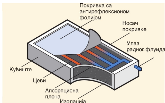
Слика 1. Делови равног плочастиог ПТСЕ са покривком
