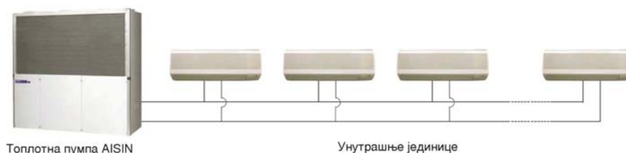
Слика 11. AISIN гасна топлотна пумпа и унутрашње јединице са директном експанзијом
