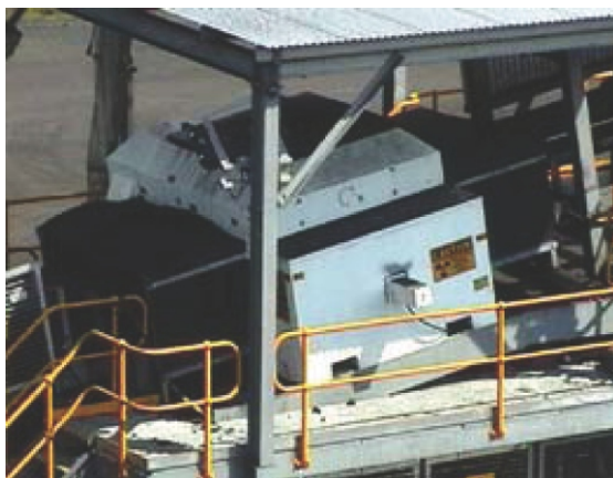
Слика 6. Компактни SQM™ анализатор
