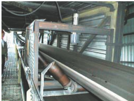
Слика 2. Радиоактивни онлајн анализатор
