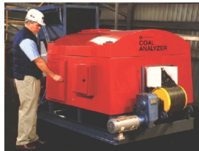
Слика 4. Елементарни cross belt анализатор пепела у угљу
